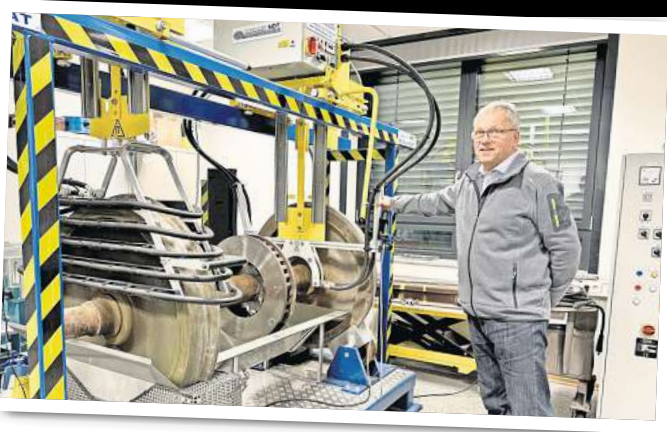
Ralf Holstein, Geschäftsführer der DGZfP Ausbildung und Training GmbH zeigt eine Halbspule zur Prüfung von Radsatzwellen. Foto: Martin Ferch
